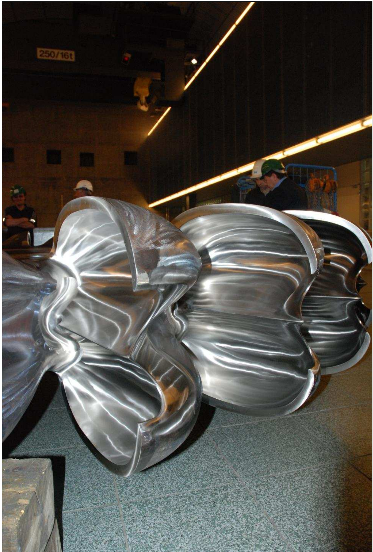
5 à 7 du CREM, 9 avril 2009 : Roue Pelton de la centrale hydraulique de Cleuson-Dixence, ALPIQ, Bieudron
