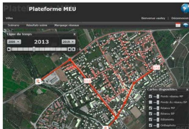
La plateforme MEU est une application web, orientée GIS, pour le management, le monitoring et la planification de systèmes énergétiques à l'échelle de zones urbaines.
